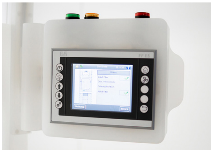
SPS-Kontrollpanel zur Steuerung und Überwachung der technischen Parameter in den Reinraumanlagen. © MK Versuchsanlagen
