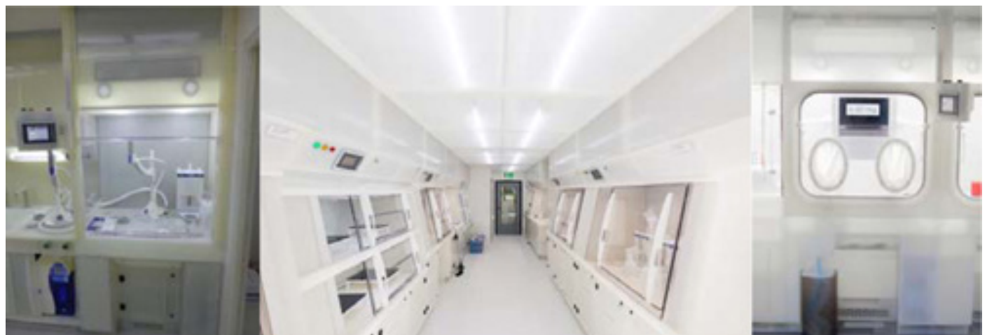
Varianten der zentralen Versuchsanlagen v.l.: Vertikale Laminar-Flow Anlage, horizontale Laminar-Flow Reinraumzeilen, Isolator mit Handschuheingriffen. © MK Versuchsanlagen
